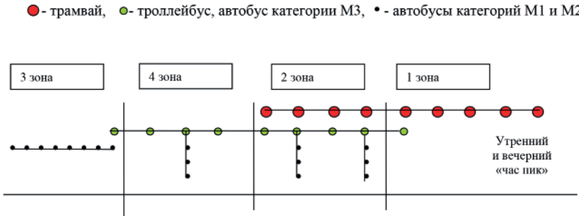
Рис. 5.7. Предлагаемое распределение систем транспорта, типа и категорий подвижного состава на маршрутах ГПТОП по зонам в утренний и вечерний «час пик»
