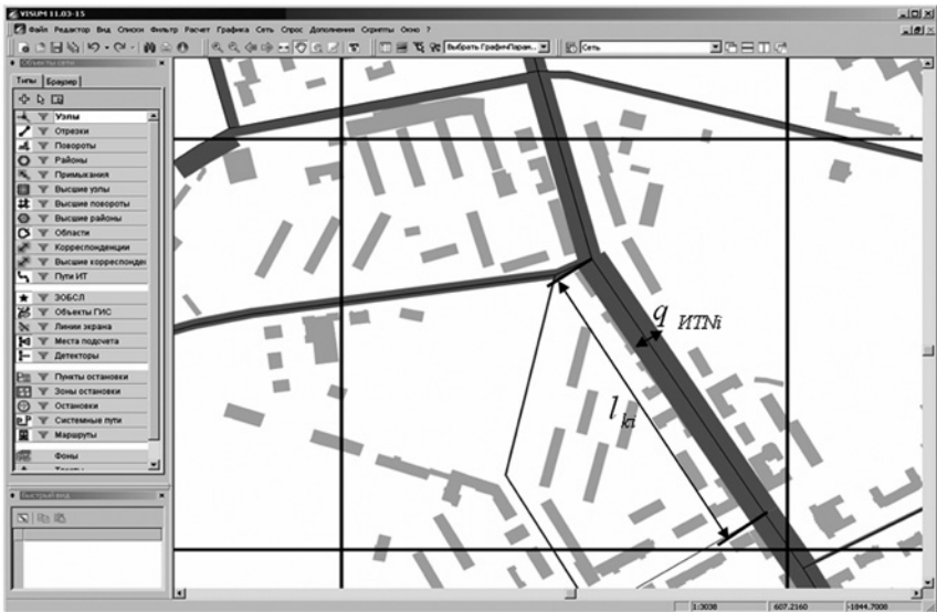
Рис. 3.33. Параметры для расчета объема движения для индивидуального транспорта в k -й ячейке нагруженной сети
