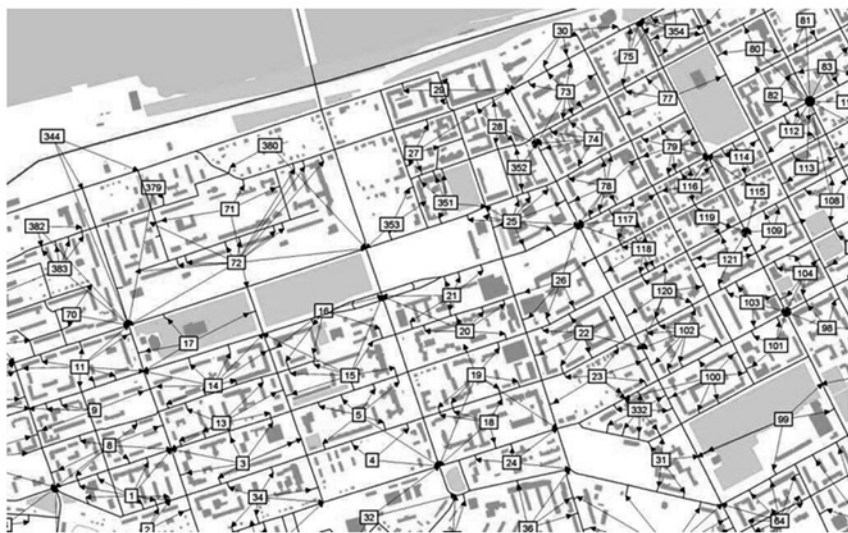
Рис. 2.6. Центры транспортных районов и их возможные связи с графом улично-дорожной сети города
